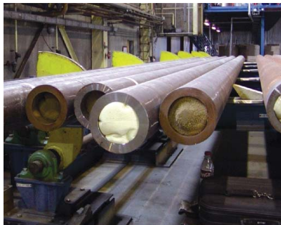
Juntas de tuberías utilizadas para construir un riser en aguas profundas. En este caso las tuberías tienen un diámetro interno de 160mm, con un espesor de 40mm.
